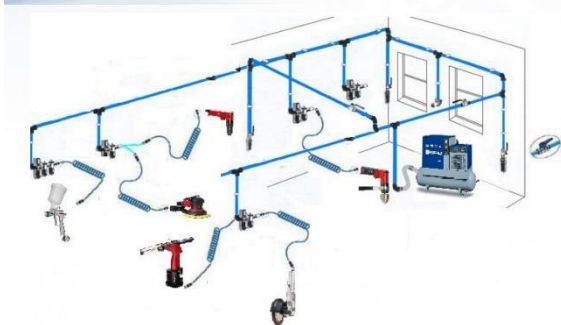
Примерная схема пневматической системы с подключением различных потребителей сжатого воздуха
